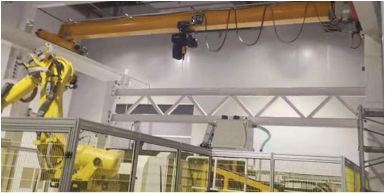
单梁起重机 一、产品构成：电动单梁起重机，主要由主梁、横梁装置、运行小车、电动葫芦、限位装置及控制系统等组成；二、产品特点1. 配置急停开关、短路保护、失压保护、相序保护等功能；2. 起升、小车、大车三机构单独控制，能单独或同时运行；3. 所有连接采用快插式重型航空插头插座，密封好，接插牢固，便于维护；4. 插头连接部位采用塑料套管绝缘保护；5. 小车限位装置，可根据实际使用调整位置；6. 移动供电系统采用起重机的PVC扁电缆，耐压等级达到 $450/750\text{V} 7$ 小车移动供电系统采用内置式电缆滑车、镀锌轨道和扁电缆等供电；8. 超载限制器；9. 上下限位开关；三、适用场合多用于起重量小、频繁程度不高的场合。
